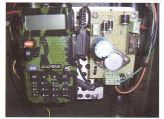
volt, il problema principale rimane il calore prodotto e la necessità di un più razionale accesso all'input/output, ovvero alla gestione del PTT e della bassa frequenza. Descrivo qui di seguito una "docking station" da me utilizzata per un Baofeng UV-5R; il modello non è determinante: ciò che verrà presentato può servire ad innumerevoli altri modelli di palmari cinesi.
