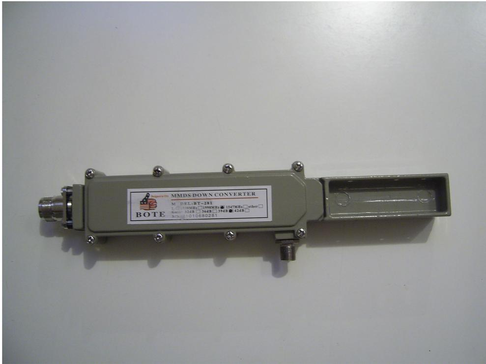
Il down-converter ha bisogno di una sola modifica : la rimozione dell'antenna in dotazione e la relativa sostituzione con una presa N femmina da pannello.
